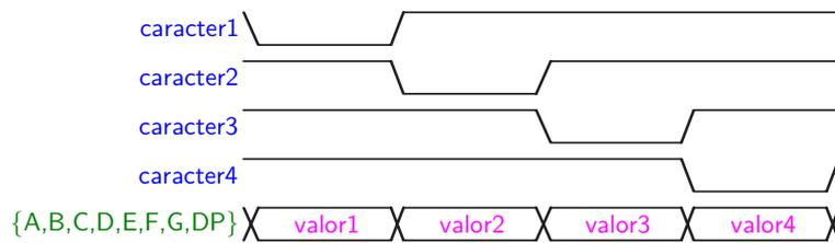
Figura 3.4: Diagrama temporal de la multiplexación.
