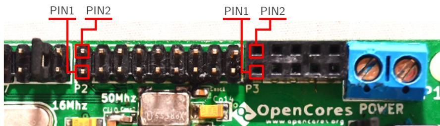
Figura 3.7: Conectores para entradas y salidas de propósito general.
