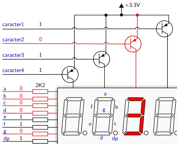
Figura 3.3: Conexión del display de siete segmentos cuádruple.
