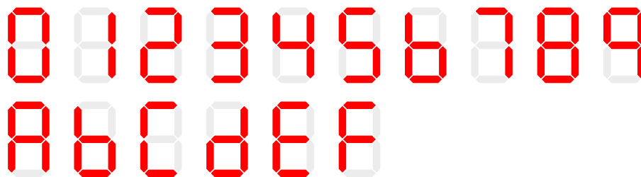
Figura 3.5: Representación de caracteres comunes en los displays de siete segmentos.
