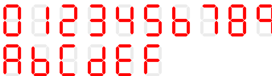
Figura 2.9: Representación de caracteres comunes en los displays de siete segmentos.
