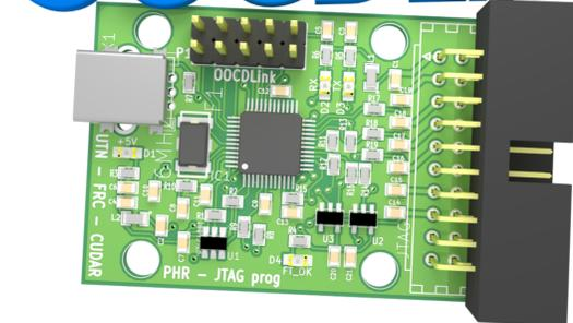
Esta placa es la interfaz que permite la comunicación entre una computadora y la placa PHR. Su característica modular, o de circuito separado de la placa PHR principal, hace que su utilización no quede restringida a la FPGA y posibilita la interacción con los múltiples dispositivos que soportan JTAG.
