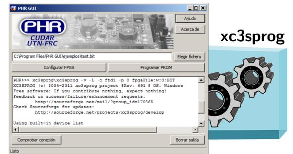
Para transferir el diseño del usuario a la FPGA, PHR se sirve de las funciones de **xc3sprog**, un conjunto de aplicaciones de licencia libre que funciona en línea de comandos y que puede programar varios dispositivos mediante JTAG. No obstante su funcionalidad, xc3sprog puede resultar no intuitivo para el usuario principiante, por lo que se ofrece una interfaz gráfica para invocar a xc3sprog de una manera muy simple.
