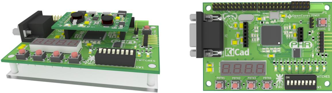
La PHR consiste fundamentalmente en tres módulos de soporte físico. El módulo principal es la *placa PHR* donde se encuentran el chip FPGA, relojes, interfaces de entradas y salidas, periféricos (tales como LEDs, botones, llaves DIP, Displays de siete segmentos), etc. Además tiene conectores especiales para otros dos módulos sin los cuales la placa principal carece de funcionalidad.
