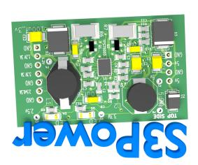
1.2V, 2.5V y 3.3V arranque. Los voltajes utilizados por la FPGA son de tres valores de tensión y distintas características de conmutadas. Permite suministrar energia regulada con La placa S3Power tiene una fuente lineal y dos fuentes
