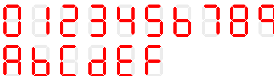
Figura 2.9: Representación de caracteres comunes en los displays de siete segmentos.
