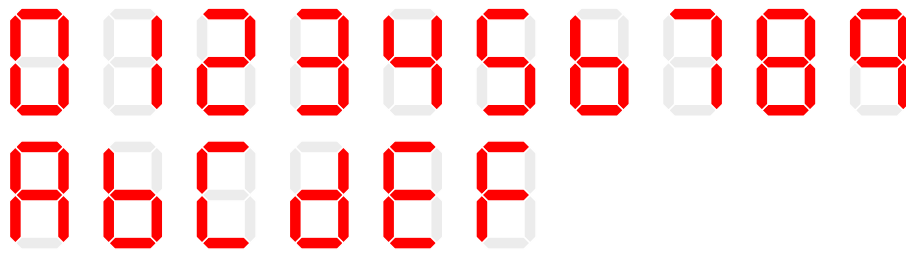
Figura 2.10: Representación de caracteres comunes en los displays de siete segmentos.
