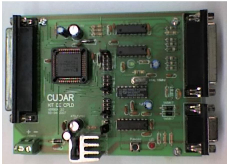
Figura 2.2: Placa programadora de CPLD.
