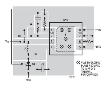
GND  $\otimes$  $\otimes$ 8 SYNC 9  $\otimes$ 3 6  $V_{IN}$ 8  $\otimes$ 5 SHDN ⊗ VIAS TO GROUND PLANE REQUIRED TO IMPROVE THERMAL PERFORMANCE 3580 F10  $V_{OUT}$
