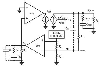
$\text{C}_{\text{C}}\text{:}$  Compensation capacitor  $\text{C}_{\text{OUT}}\text{:}$  Output capacitor  $\text{C}_{\text{PL}}\text{:}$  Phase lead capacitor
